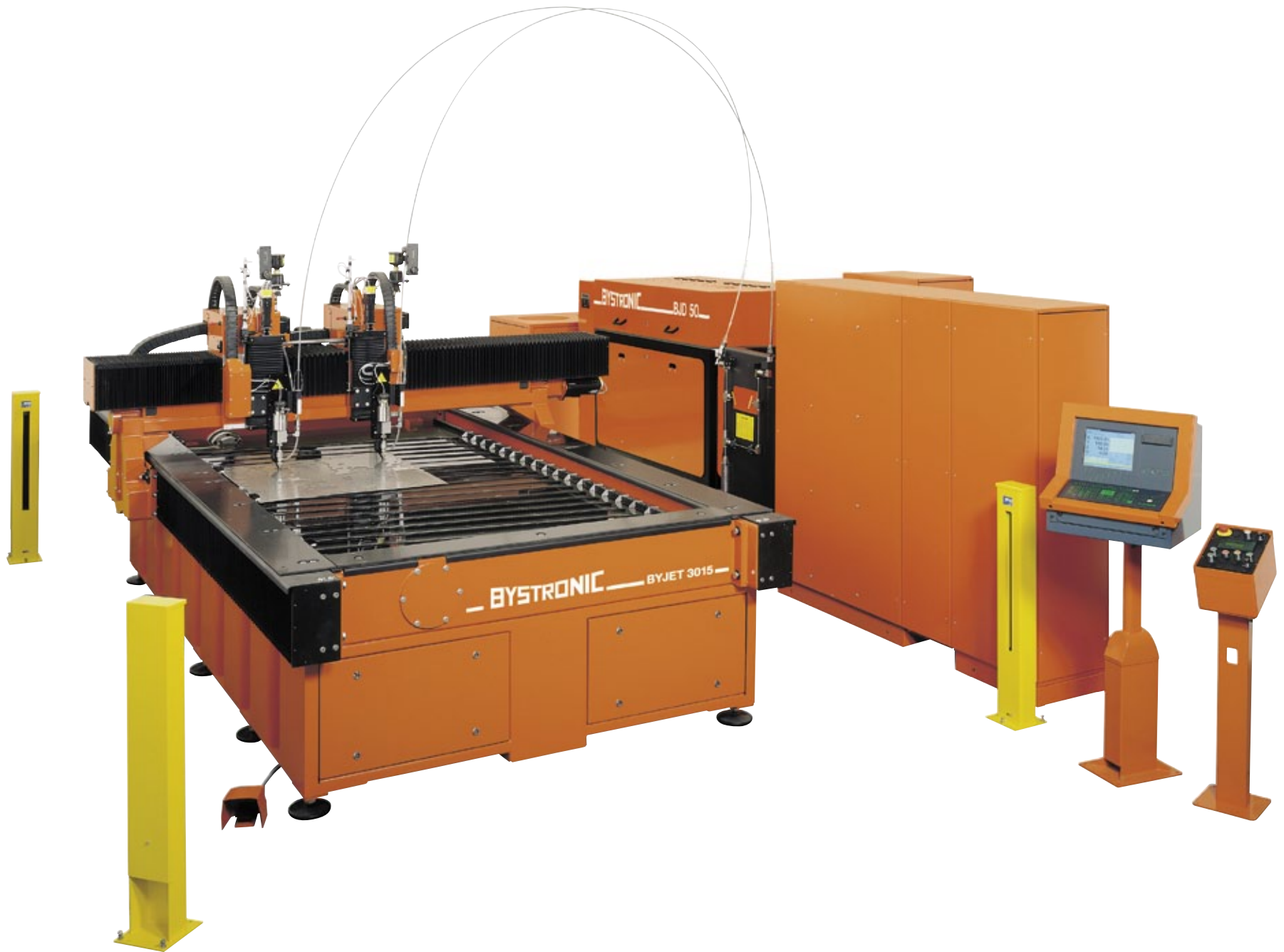
▲ Byjet 3015 2-Schneidkopf-Maschine mit integrierter Höhenabtastung und Abrasivzufuhr Maximaldruck: 2800 bar
