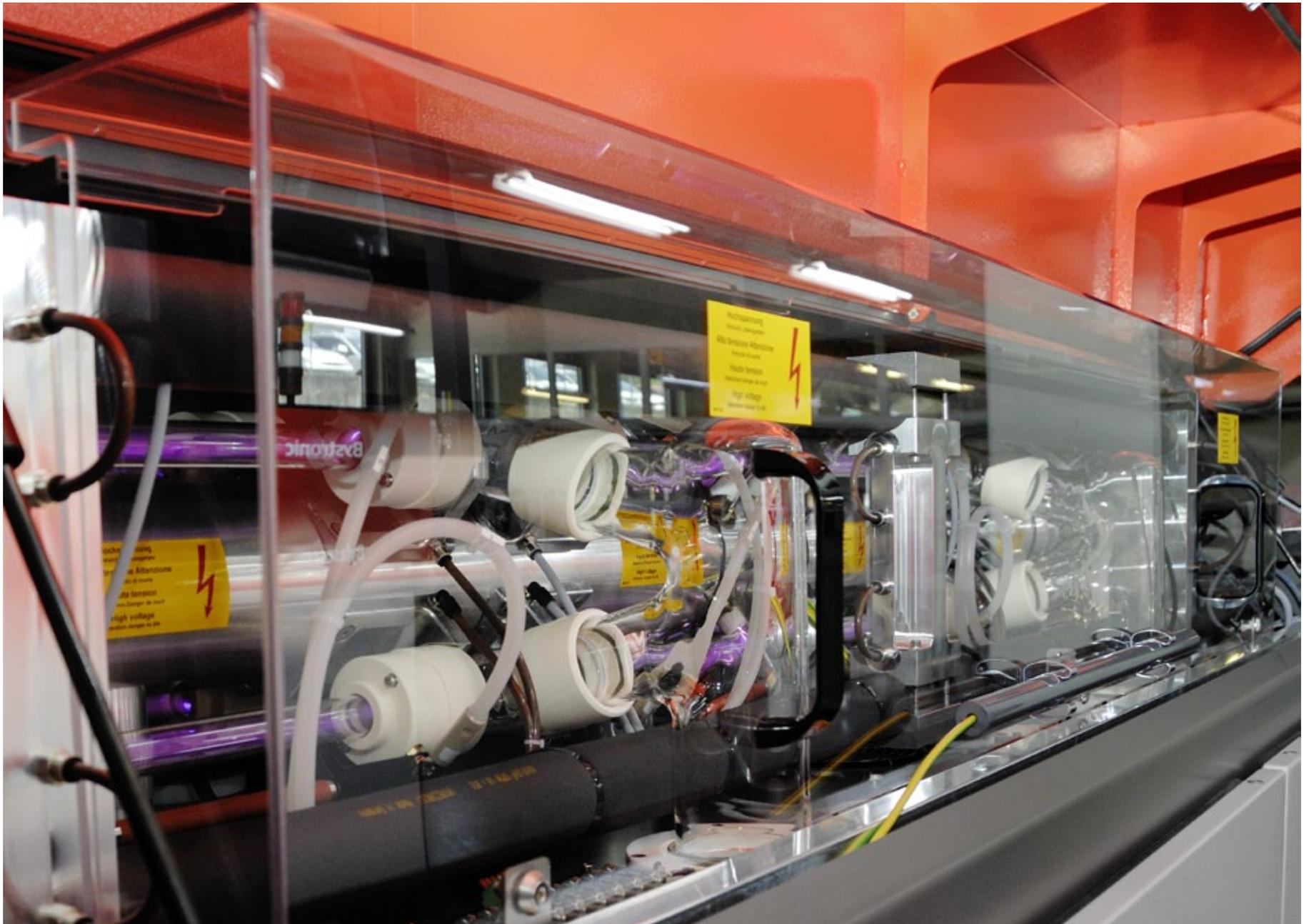
▲ Die **Laserquellen** der zweiten Generation basierten auf der Halbleiteranregung
