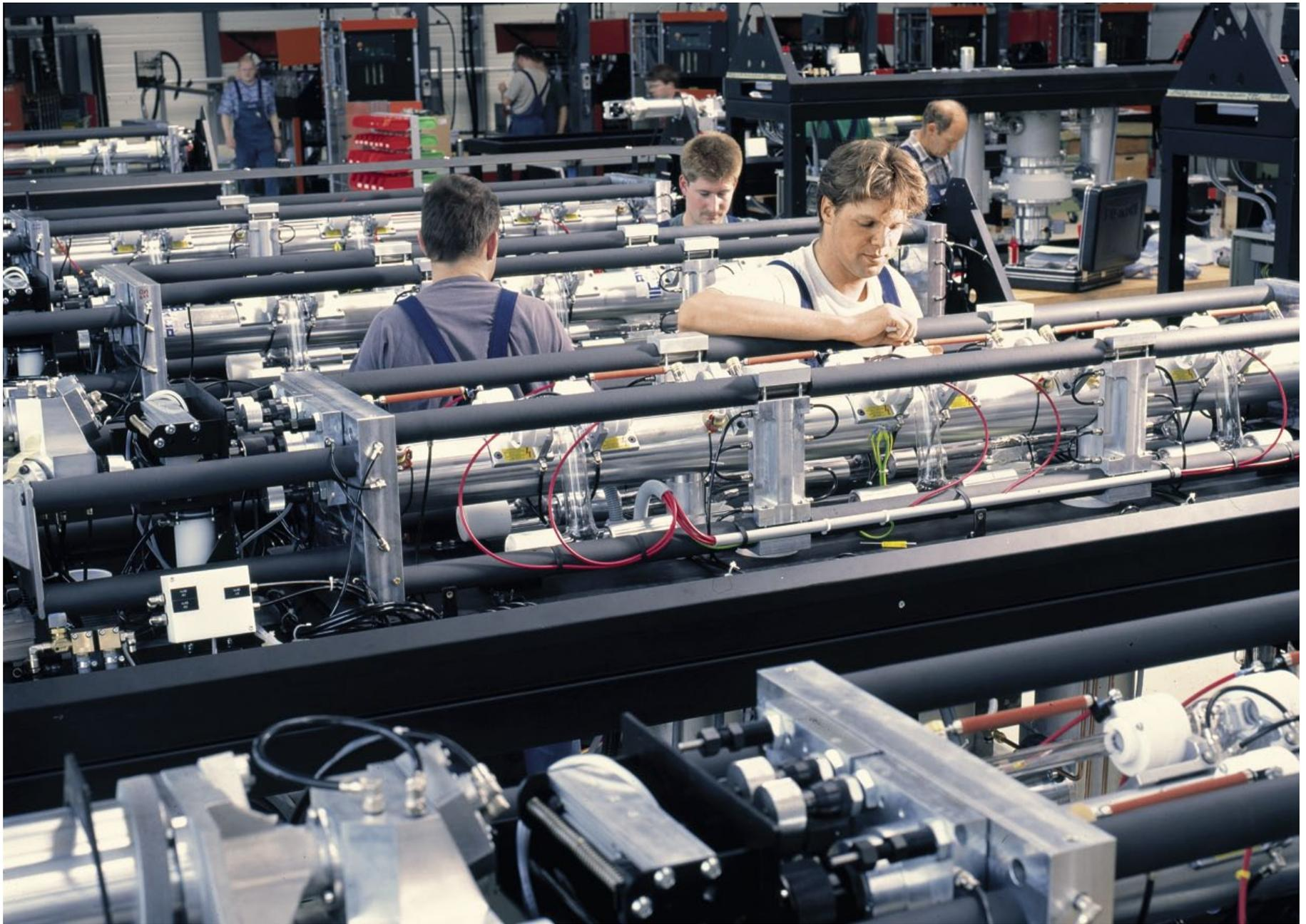
▲ Resonatormontage Bis 1999 produzierte Bystronic ausschliesslich röhrenangeregte Laser
