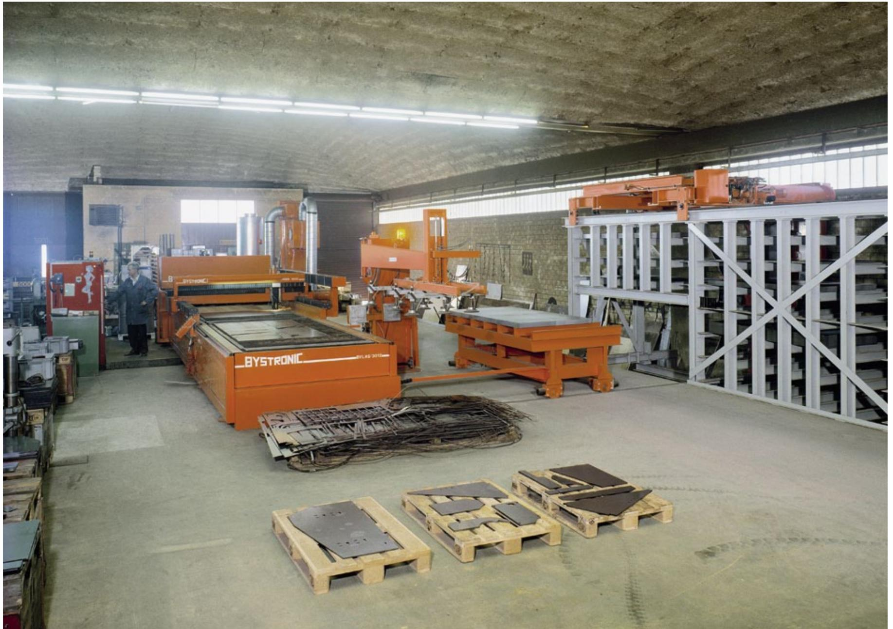
▲ Der Samro-Prototyp war die erste Maschine dieser Grösse mit fliegender Optik. Dass Bystronic als erster Anbieter eine industrietaugliche Lösung mit fliegender Optik und Wechseltisch anbieten konnte, war der Schlüssel zum Erfolg.
