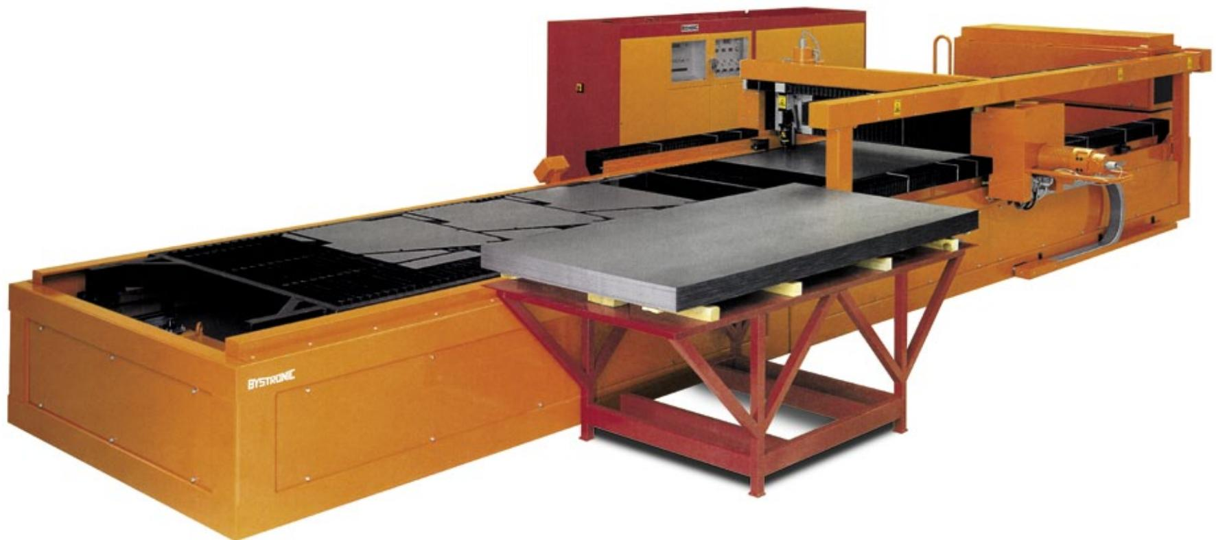
▲ **Bylas 3015**    Laserleistung: 500/1000 Watt    Maximale Achsgeschwindigkeit: 80 m/min    Maximale Bahnbeschleunigung: 1 m/s<sup>2</sup>
