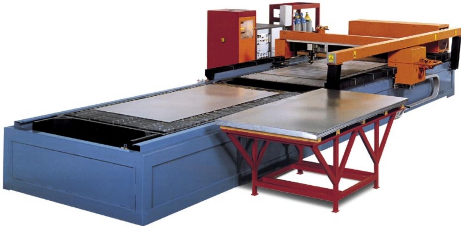
▲ Bystronic kaufte in England einen 500-Watt-Laser, montierte ihn auf eine ihrer Glasschneidmaschinen und fing mit diesem Prototyp bei Samro an, Blech zu bearbeiten.
